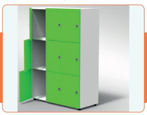
Armadio con nove ante e nove vani realizzato in conglomerato fibrolegnoso nobilitato spessore 18mm. Bordi perimetrali in abs da 3. Le ante, colorate, sono bordate con abs da 3mm. Ognuna di queste dispone di quattro robuste cerniere. L'armadio è provvisto di tre divisori centrali e sei ripiani fissi che lo dividono in nove vani. In aggiunta si possono avere altri due tipi di piedini opzionali (in faggio e in metallo) e chiusure con serratura e chiave (VAS4087).
